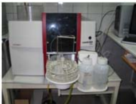
Nagyfelbontású, folytonos fényforrású multi elemes AAS készülék
